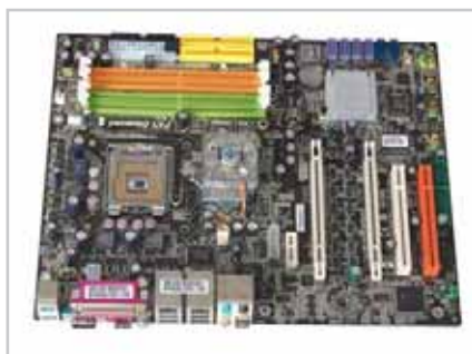
MSI P4N Diamond - Placă de bază cu noul chipset nForce 4 SLI Intel Edition și foarte bine dotată (doar face parte din seria de vârf Diamond). Computarea între modul de lucru single GPU / SLI se face direct din BIOS, fără ajutorul plăcuței suplimentare.
