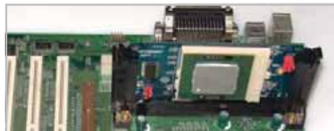
Adaptorul SLOT-T de la Slot1 la Socket 370.
