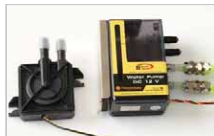
Pompa reprezintă motorul întregii instalații. Ea nu trebuie să pornească fără a fi umplută în prealabil cu apă. Se pot observa orificiile pentru aerisire la pompa din dreapta.
