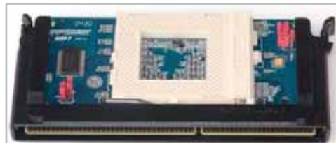
Adaptorul SLOT-T de la Slot1 la Socket 370.
