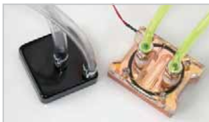
Cele două incinte care joacă rol de radiator pentru procesor, cu baza de cupru. La cel transparent din dreapta (al sistemului Thermaltake) se pot observa canalele pe unde apa circulă în incintă.
