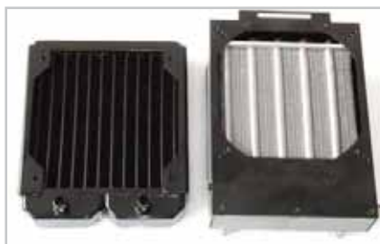
Radiatoarele celor două sisteme, ce vor fi răcite de ventilatoare. Tuburile ce conduc apa sunt răcite de niște lamele suplimentare foarte subțiri.
