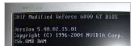
Folosind programul NiBiTor am schimbat mesajul de boot al plăcii MSI NX6800GT.
