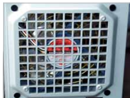
Ventilatorul de evacuare a aerului cald din spatele carcasei este montat cu ajutorul șuruburilor de cauciuc pentru prevenirea transmiterii vibrațiilor.
