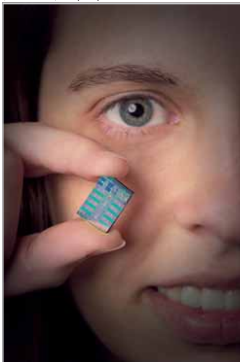
Pastila de siliciu a procesorului Cell are o suprafață de 221 mm 2 .
