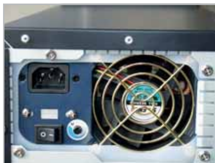
Sursa Enermanx Noisetaker a fost montată împreună cu o garnitură de silicon pentru atenuarea eventualelor vibrații produse de ventilatoarele din sursă.
