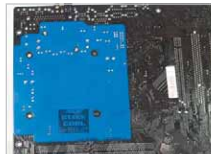
Pentru un procesor așa încins cum e Prescott-ul, producătorii și-au luat precauții speciale – ASUS Stack Cool menține socket-ul la răcoare.
