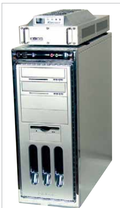
Sistemul IT Direct cu SLI. Se observă răcirea Koolance ce este necesară pentru atingerea unei așa frecvențe mari a procesorului.
