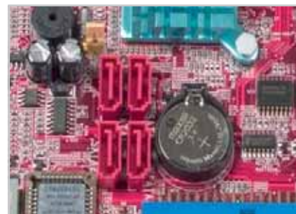
Conectorii SATA, extrem de fragili până acum, au un nou design menit să le asigure fiabilitatea.
