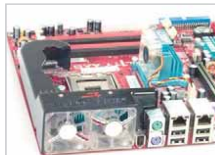
ABIT OTES – dispozitivul ce asigură răcirea regiunii fierbinți din jurul socket-ului, în cazul plăcii FATALITY.
