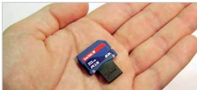
Designul mecanic special de la Sandisk permite folosirea cardurilor SD direct într-un port USB.
