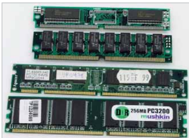
De sus în jos: Memorii SIMM, memorie SDRAM și memorie DDR-SDRAM. Dacă PC-ul dumneavoastră nu are memorii DDR, upgrade-ul nu-și are rostul.
