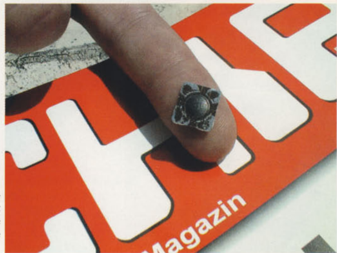
Cipul din spatele contactelor unui smart card este protejat de materialul de culoare neagră.
