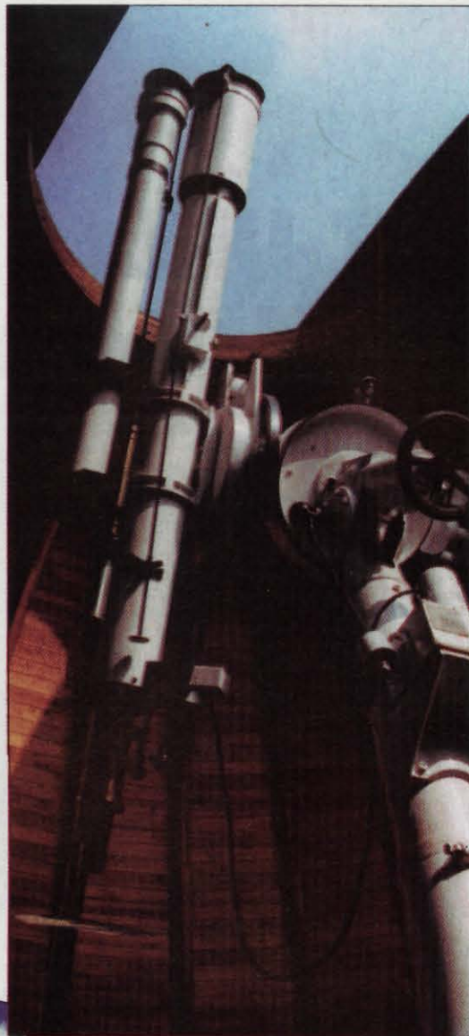
Astrograful cu distanța focală de 6 m și diametrul de 38 cm al Institutului Astronomic al Academiei Române.
