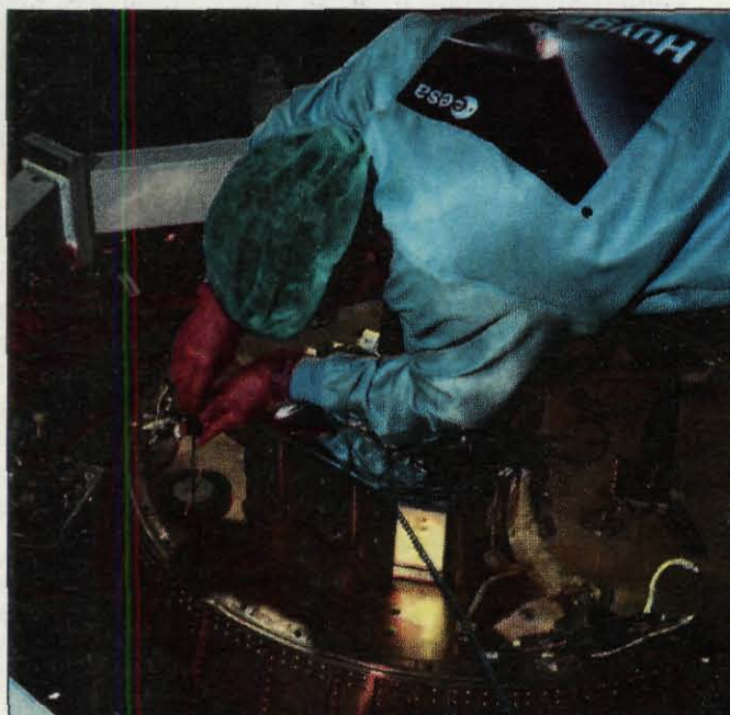
Montarea unui CD-ROM pe modulul de coborîre.
