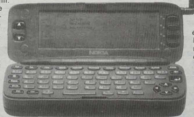
Telefon, calculator și fax sunt reunite într-o singură carcasă în Communicator 9 000, produs de Nokia.
