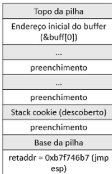
Imagem 10: layout da pilha do servidor com requisição estruturada
