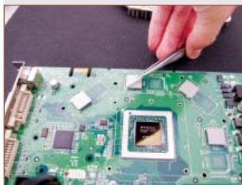
➔ Nu uitați înlăturarea protecției padurilor termice puse pe memoriile!
