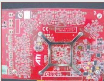
➔ Cele opt șuruburi ce fixează radiatorul standard.
