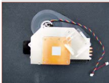
➔ Pasta termică este acoperită de un capac ce se va înlătura.
