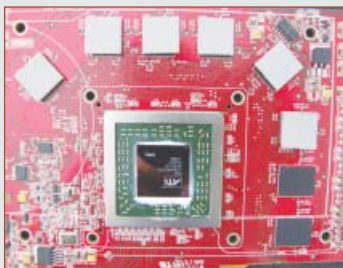
➔ Aici se observă GPU-ul curățat și aplicarea padurilor termice.
