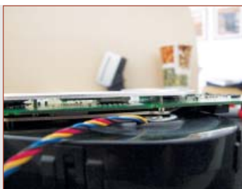
➔ Padurile termice au un contact perfect cu radiatorul și memoriile.
