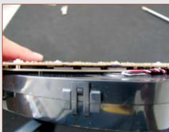
➔ Și în cazul plăcii ATI se verifică montarea corectă a padurilor.
