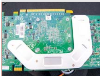
➔ Placa de aluminiu răcește memoriile și fixează radiatorul.
