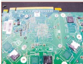
➔ Între șuruburi și PCB se pun garniturile de cauciuc din pachet.
