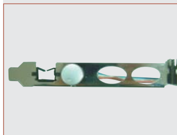
⇒ Bracket-ul prin care se trec tuburile și firele radiatorului extern.
