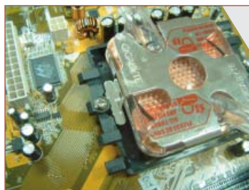
⇒ Sistemul de ghidaj al radiatorului împiedică montarea defectuoasă.
