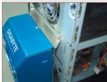
⇒ Radiatorul extern se fixează de sistemul de prindere al sursei.
