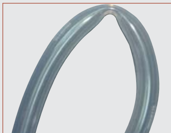
⇒ La finalul operațiunii verificați ca nici unul din tuburi să nu arate așa!
