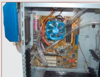
⇒ Sistemul de răcire pe apă, la finalul operațiunii de instalare.
