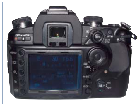
➔ Ecranul LCD de 2.5 inch poate fi folosit pentru vizualizarea informațiilor și navigarea în meniuri
