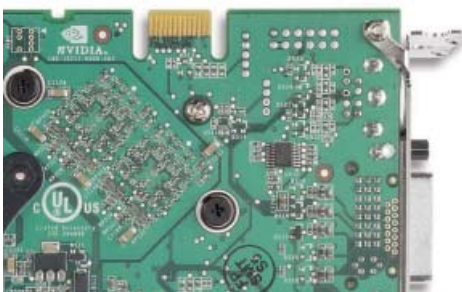
Conectorul MIO responsabil de comunicarea între cele două plăci GeForce 6800
