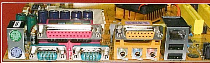
Conectorii din spatele carcasei nu sunt standard
