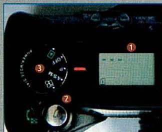
1 ecran LCD secundar 2 buton start 3 rotită schimbare mod de lucru
