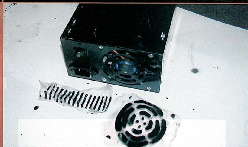
20 Vopsirea sursei s-a dovedit o operațiune delicată. A fost desfăcută și i s-a lipit scotch pe interior în dreptul găurilor. După vopsire acesta a fost scos.
