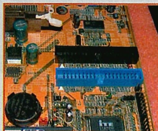
Conectorii IDE sunt bine plasați, neîncurcându-se cu alte componente
