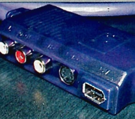
Controller cu conectori audio in/out, S-video in/out, video composite in/out, FireWire și S/PDIF IN.
