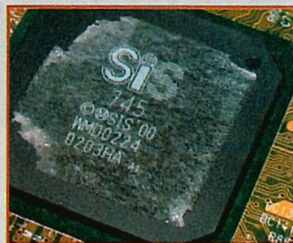
Chipset-ul SiS745 peste care era lipit un radiator
