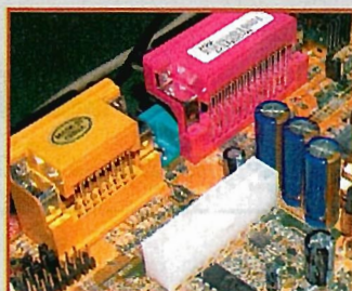
Plasarea conectorului de alimentare implică trecerea cablului peste cooler
