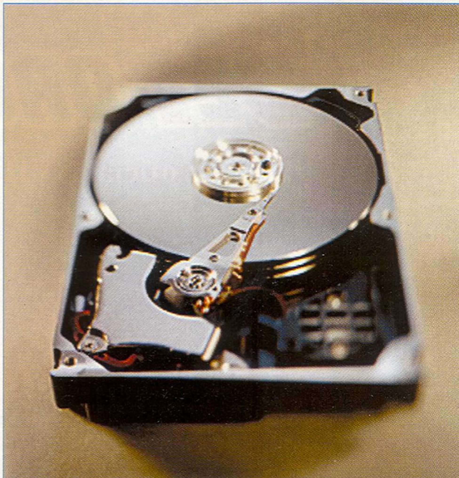
Așa arată interiorul unui Hard Disk. Observați platanele și brațul pe care se află capetele de citire-scriere
