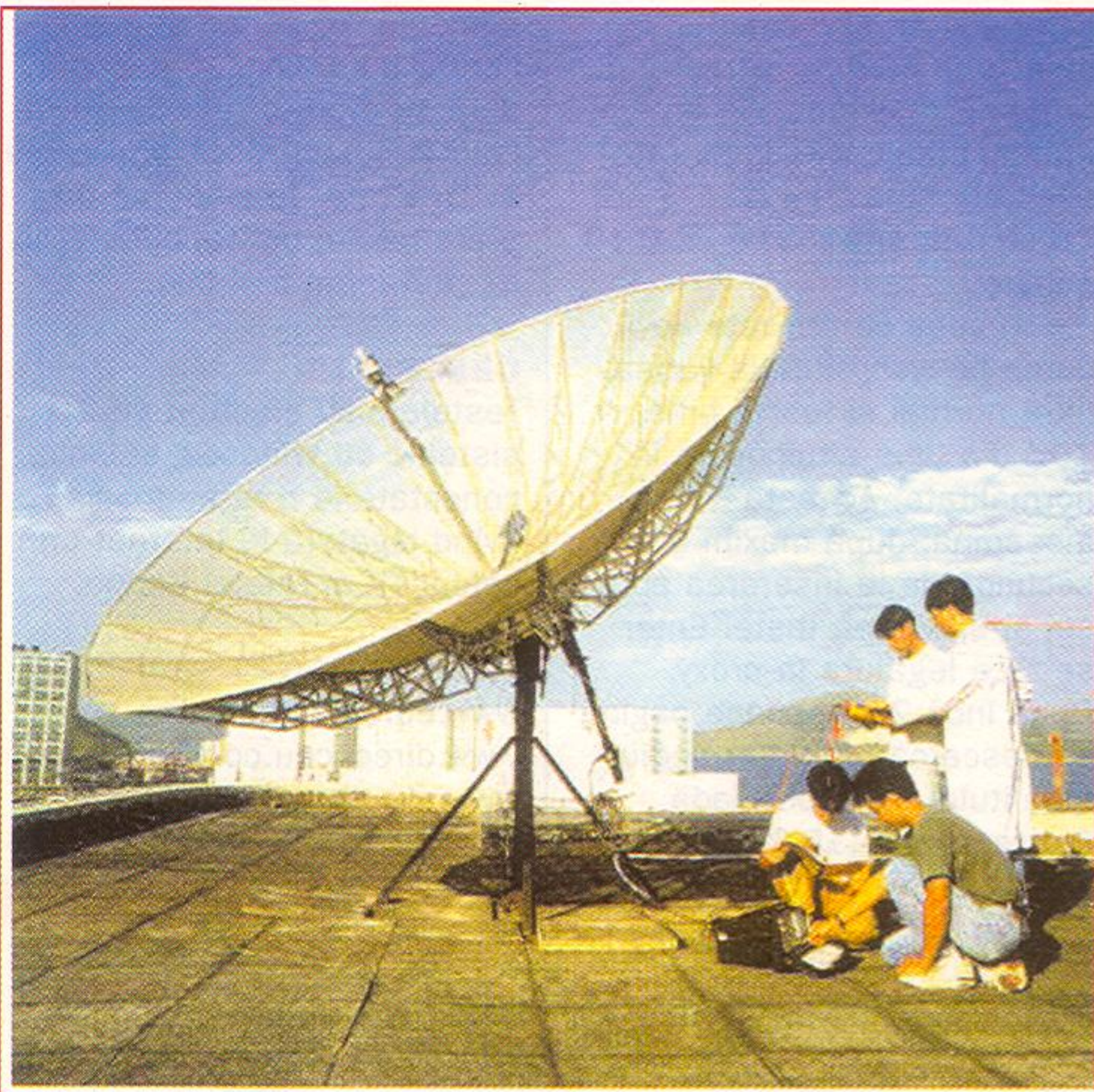
Pentru o recepție cu o acoperire a semnalului de peste 90% aveți nevoie de o antenă de peste 2m. Însă și 1.5-1.8m e bine.
